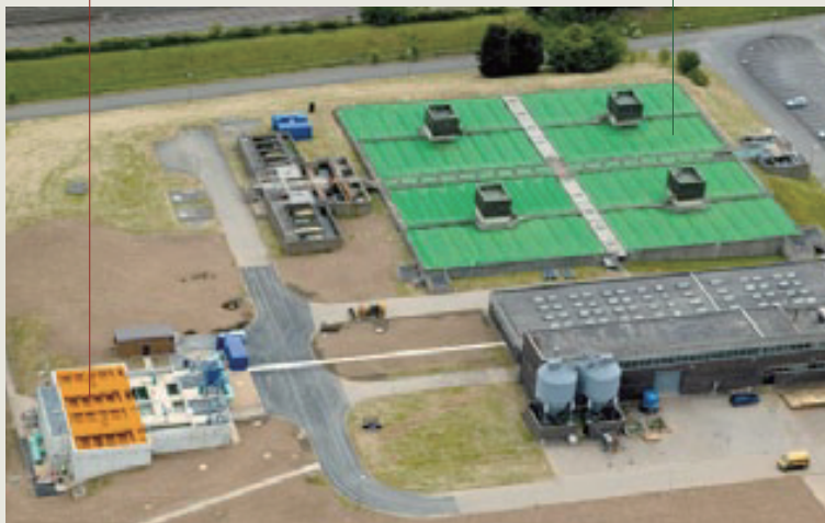
ロンドン・アイヴァー浄水場 (180,000m 3 /d) ACTIFLO®プロセスと従来法とのスペース比較
