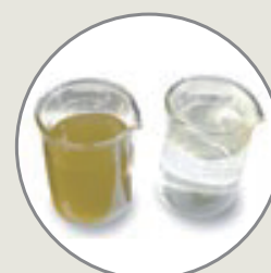
左: 藻類を含んだ排水 右: 処理水
